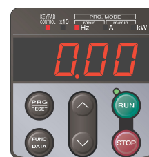
図 4.3 電源投入時の LED モニタ表示
